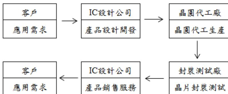
客戶提出應用需求後，由本公司作為晶片產品的設計規格，再經由開發驗證流程後，將設計圖交由專業晶圓代工廠製作光罩並生產，生產完成的 IC 晶圓再交由封裝測試廠處理、測試、包裝及出貨，最後 IC 設計公司再負責銷售與客戶的產品相關應用服務。
