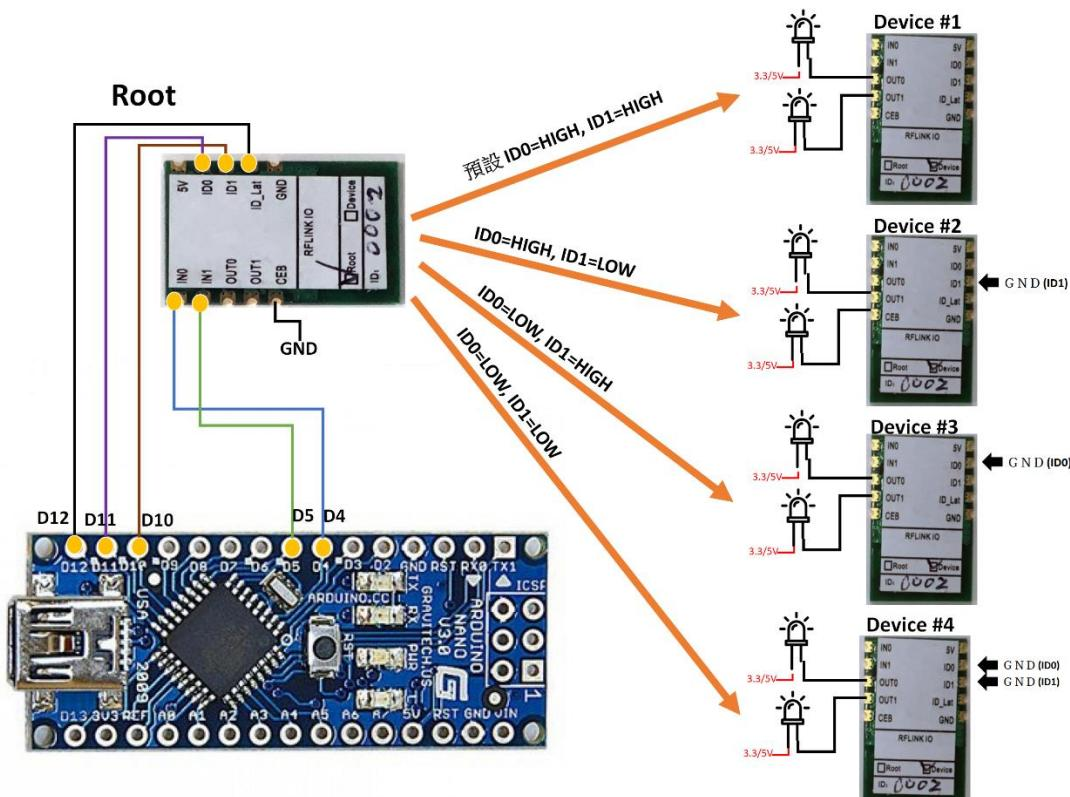
注意：與 RFLink-IO 連接的開發板 pin 腳並沒有限制特定腳位，
